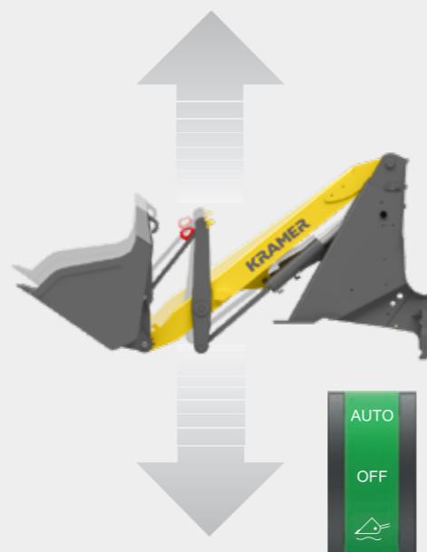
Automatisk laststabilisator förhindrar maskinen från att gunga och minskar materialförlust.
