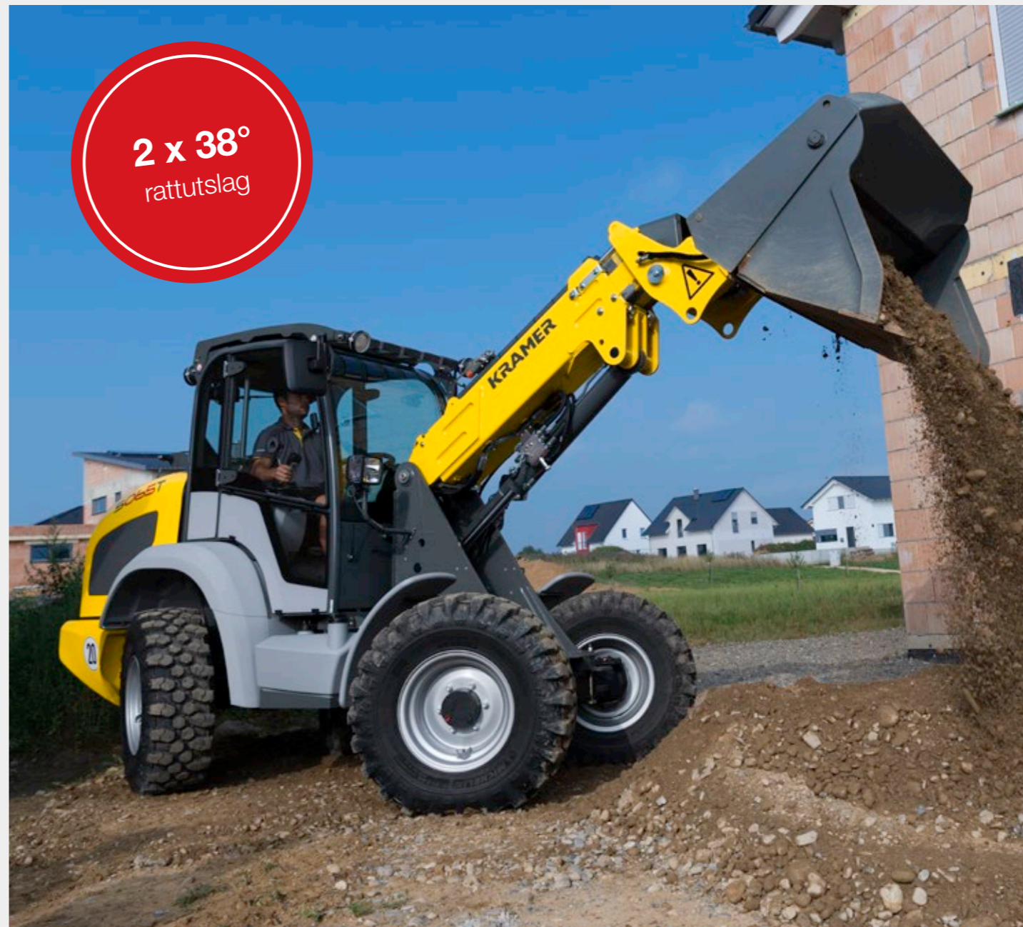
Styrning på alla hjulen extra lättmanövrerad på begränsade utrymmen
