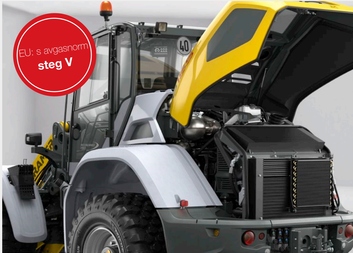
Vattenkyld fyrcylindrig rak motor med kyld extern avgasåterföring, turboladdning och laddluftskylning.
