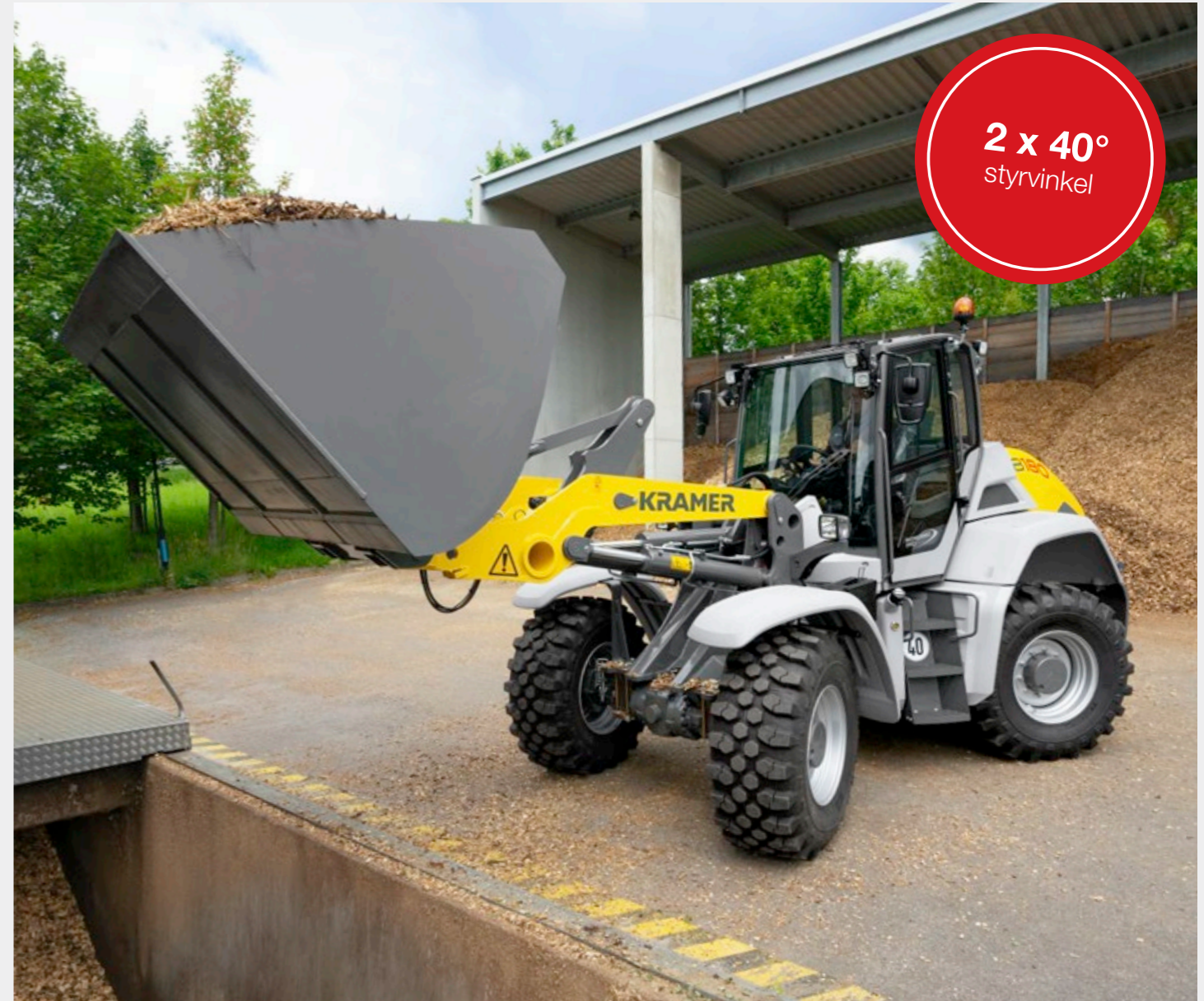
Fyrhjulsstyrning särskilt rörlig vid begränsat utrymme
